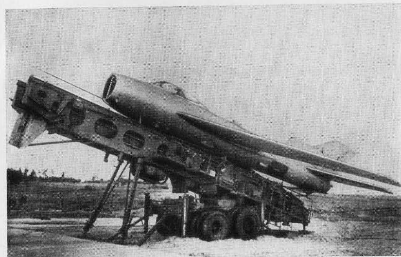
МиГ-19 (СМ-30) на установке для катапультируемого старта.
