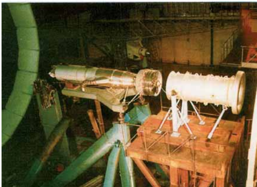
Винтовентиляторный прибор в аэродинамической трубе ЦАГИ
